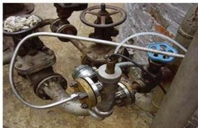
Рис. 4. Метрологический комплекс определения уровня pH
