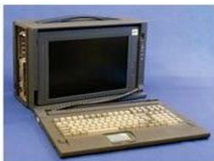
Рис. 7. Компьютер PWS-1409TP фирмы Advantech, используемый в качестве центральной вычислительной станции системы ККМ
